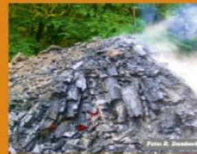
Schaumeiler bei Eppstein - Vockenhausen (Taunus) nach dem Öffnen - zu sehen ist die fertige, noch glühende Holzkohle
